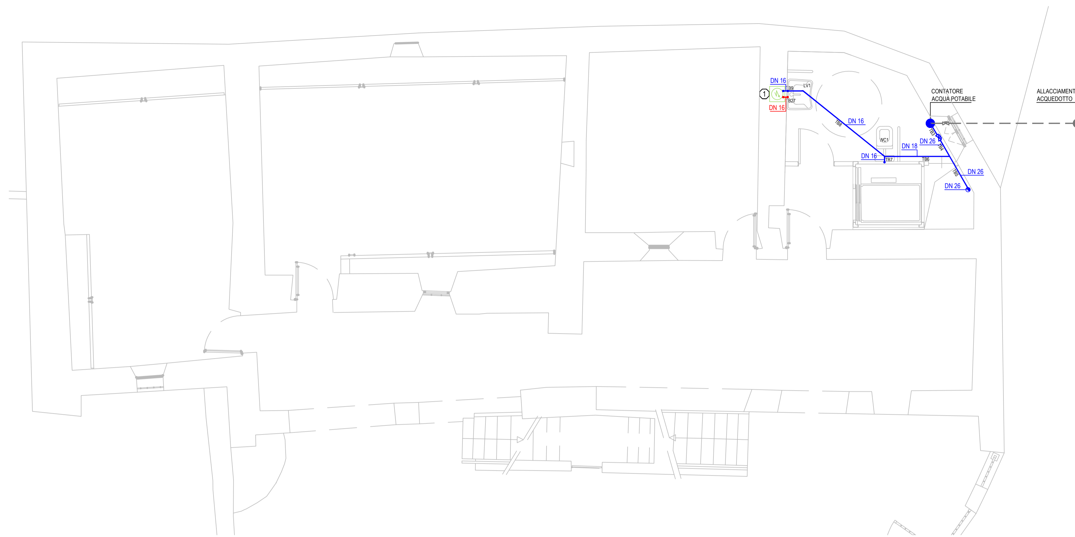
PIANTA PIANO TERRA_DISTRIBUZIONE ADDUZIONE ACQUE_scala 1:50
